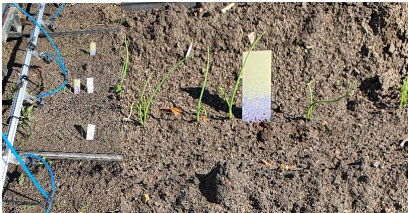
Figur 8. Sprutning vid 1 blad. Sprutduschens träffbild i höjddled bestämdes med hjälp av vattenkänsligt papper i raderna.
