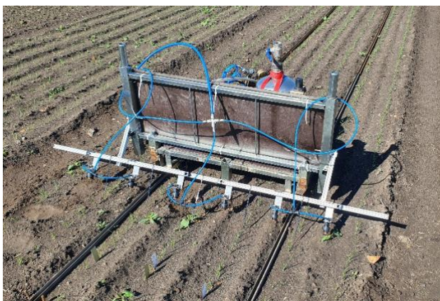
Figur 6. Specialbyggd spruta för precisionssprutningstest/demonstration som löper i räls som mätts in för kontrollerat avstånd mellan sprutmunstycke och lökrad.
